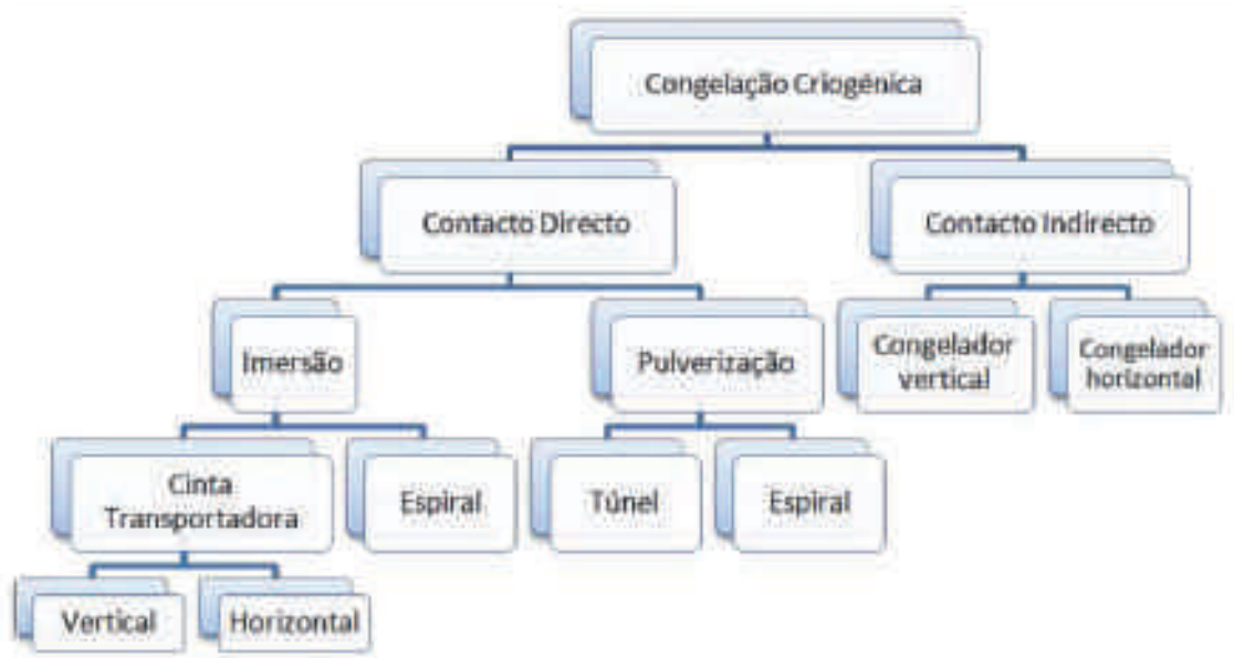
Figura 41 - Classificação dos equipamentos criogénicos (Khadatkar et al., 2004)
